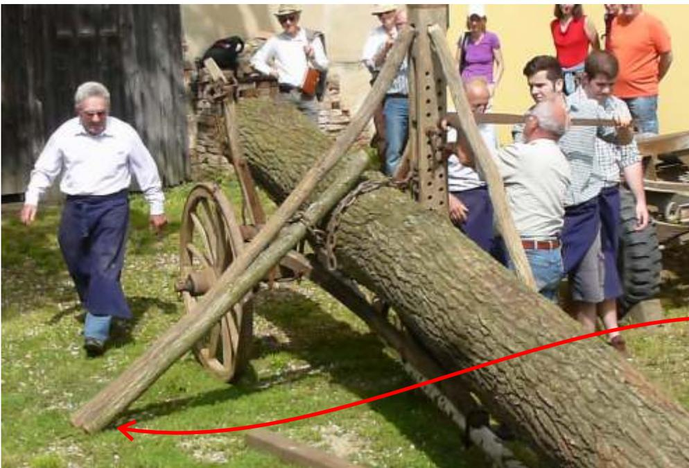
Steht der Wagen unter dem hochgehobenen Baumstamm bereit, wird dieser langsam abgesenkt und auf dem **Sattel** des Wagens abgelegt.
