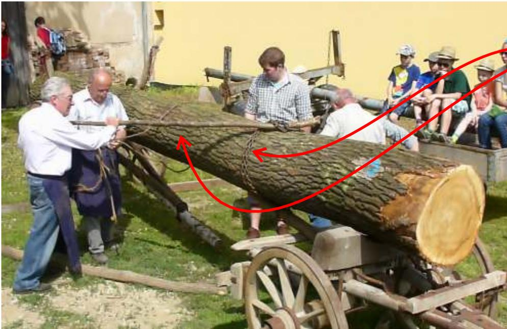
Vorne wird der Wagen mit dem Holz mit der **Roal-Kette** und der **Roal-Stange** „ang'roalt“.
