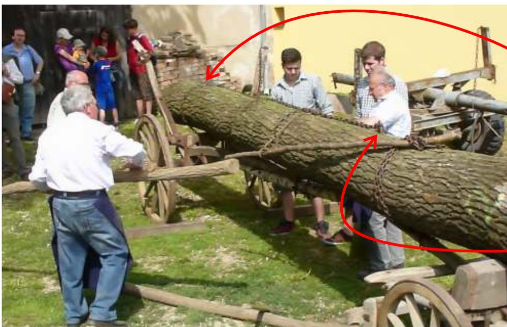
Der Baum wird mit dem hinteren Wagenteil mit der **Stempfl-Kette** verbunden.
