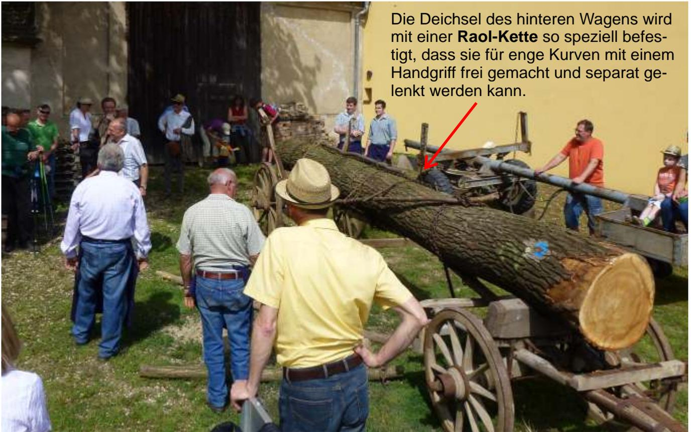
Die Deichsel des hinteren Wagens wird mit einer **Raol-Kette** so speziell befestigt, dass sie für enge Kurven mit einem Handgriff frei gemacht und separat gelenkt werden kann.
